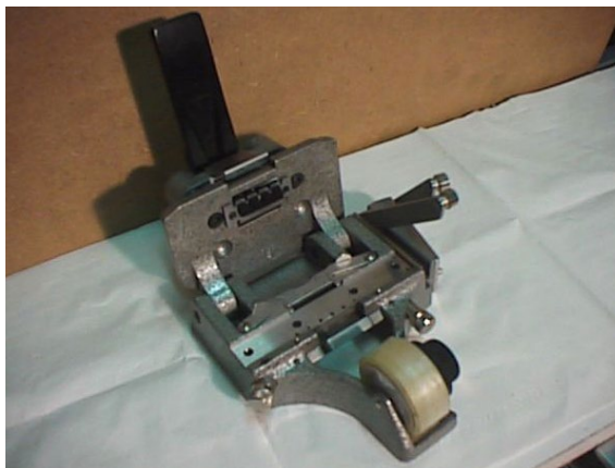
Incollatrice C.I.R. Mod. 16mm 2T a nastro adesivo a 2 taglierine per film a lettura ottica (taglio diritto) e magnetica (taglio obliquo)
