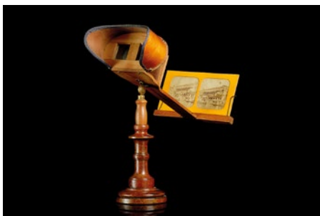
Stereoscopio Ottica Fisica Fotografia Duroni E.C. Milano per positivi su carta, Italia seconda metà del 1800, legno 28 x 14 x 8 cm con stereogramma albumina colorato per trasparenza. (Photo © Francesco Barasciutti)
